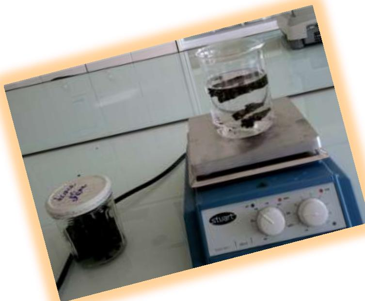
*Un exemple de production réalisée par des élèves en classe de Première S, dans le cadre d'un TPE : préparation au labo de chimie de l'encre métallo-gallique à base d'écorce de chêne (Lycée Paul Sabatier, Carcassonne)*
